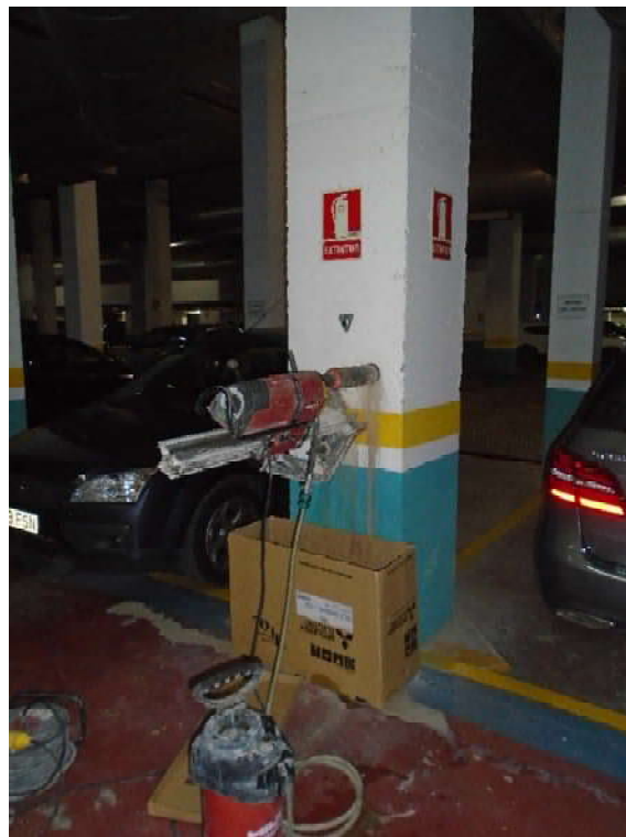
Foto 34. Vista extracción de testigo en pilar 112 en planta sótano
