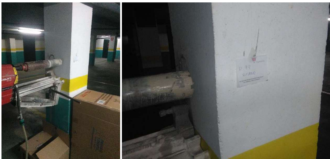
Fotos 01 y 02.- Extracción de testigos
