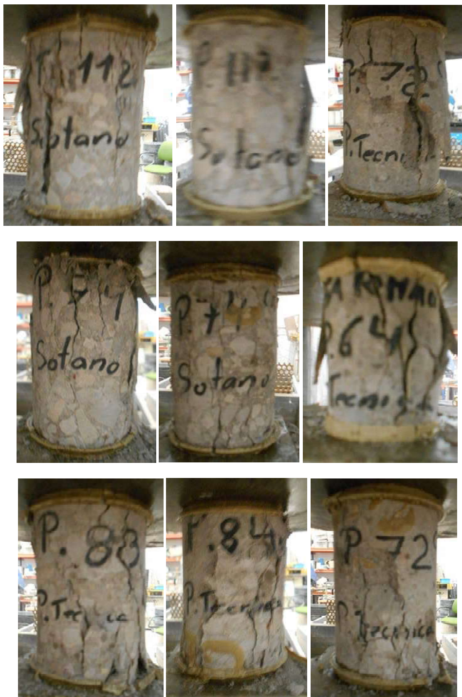
Fotos de 12 a 20.- Rotura de testigos de pilares
